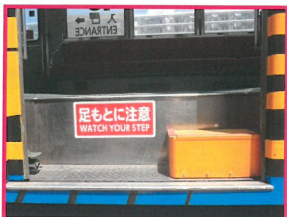
● 2段ステップ化工事を施工した電車および補助ステップ案内ステッカー(車内)
