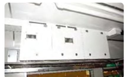
運転状況記録装置(ATC-SW型車両)
