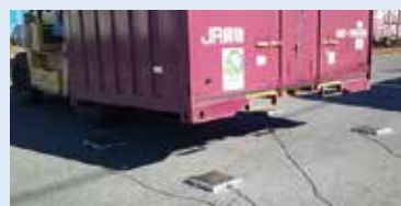
12ftコンテナの脚部4カ所の重量を計測
