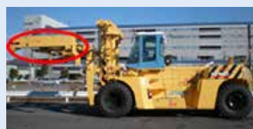
トップリフターのスプレッド部で4点の重量を測定
