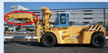
トップリフターの偏心荷重測定装置
