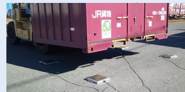
コンテナの重量バランス測定
