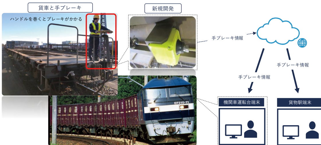
「手ブレーキ検知システム」概念図
