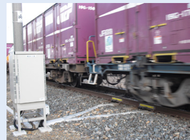
輪重測定装置による測定
