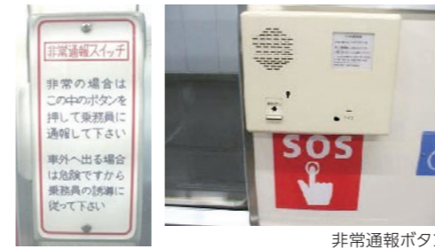
非常通報ボタン
