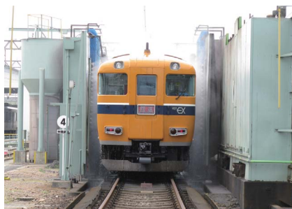
車体洗浄機で、車両の汚れを落とします。
