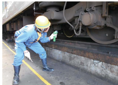
台車・ブレーキ装置の検査
