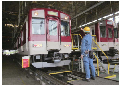
ヘッドライト、標識灯等の点灯状態の検査
