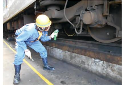
台車・ブレーキ装置の検査
