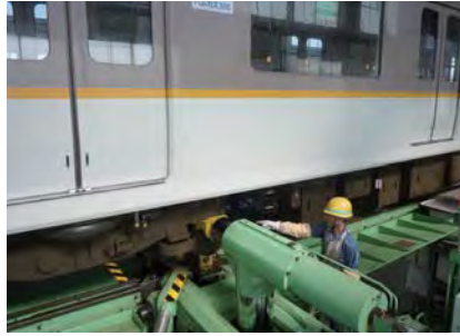
①車輪の形状を整え、快適な乗り心地を保持します。
