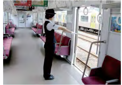
⑦ 扉「開」状態点検
