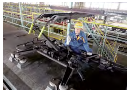
④パンタグラフの検査
