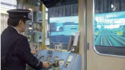
運転士用のシミュレーター装置
