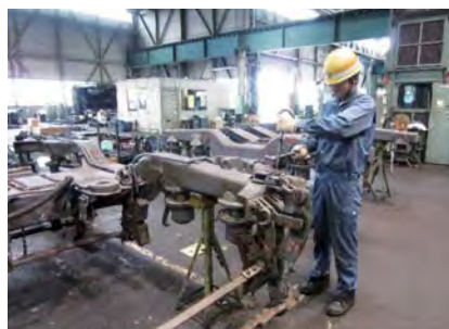
⑪ 台車の検査
