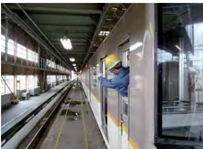
②扉開閉の検査
