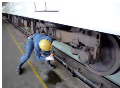
③台車・ブレーキ装置の検査
