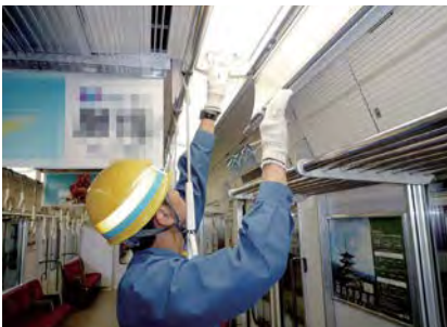
車内蛍光灯の検査
