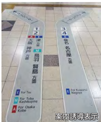
案内誘導表示 床面に案内誘導表示を行い、エレベーターに誘導できるよう改善
