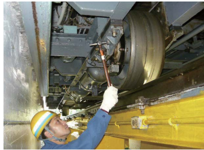
床下機器の検査
