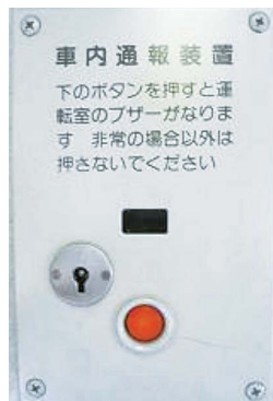
車内通報装置
