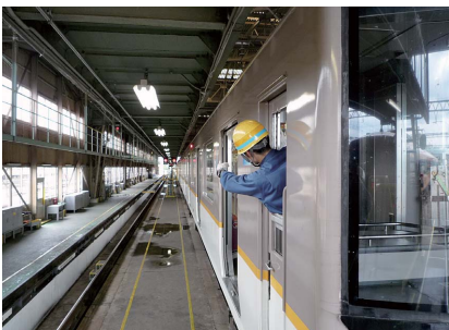
②扉開閉の検査
