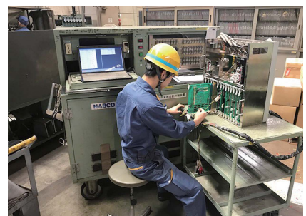
⑭ブレーキ制御装置の検査
