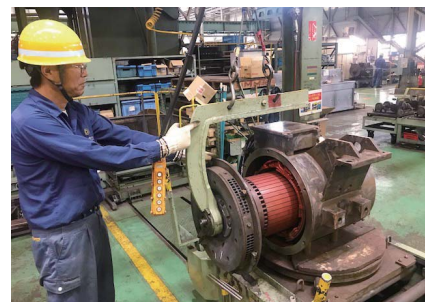
⑪主電動機の検査
