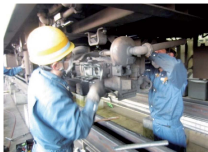
⑩電動空気圧縮機の検査
