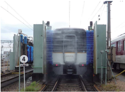
車体洗浄機で、車両の汚れを落とします。
