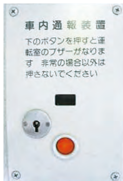
車内通報装置
