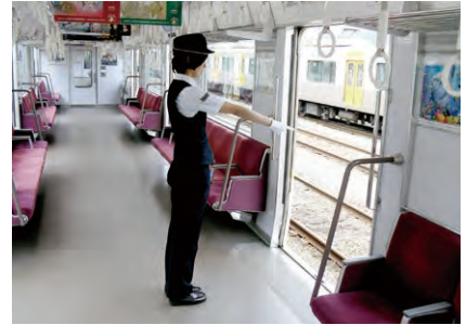
⑧扉「開」状態点検
