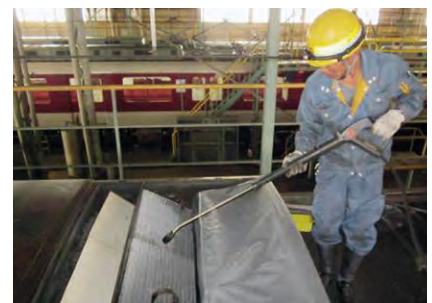
⑥クーラー室外機の清掃
