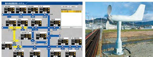
風向風速監視システム画面
