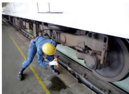
③台車・ブレーキ装置の検査
