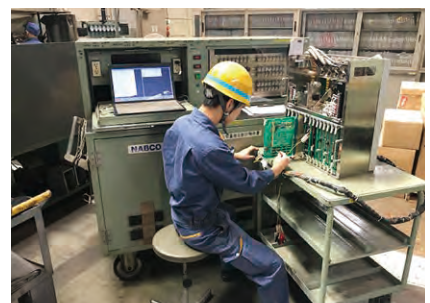
⑭ブレーキ制御装置の検査
