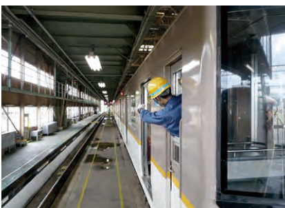
②扉開閉の検査
