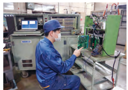
⑪ブレーキ制御装置の検査
