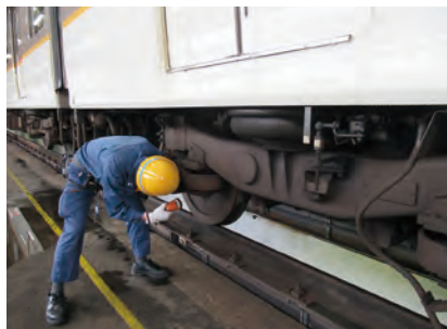
②台車・ブレーキ装置の検査
