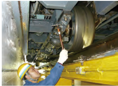
床下機器の検査
