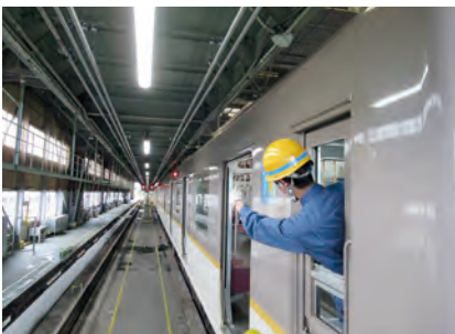
①扉開閉の検査
