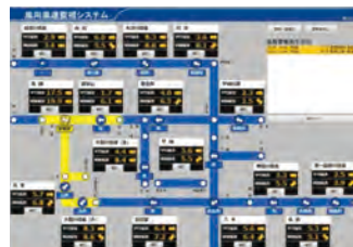
風向風速監視システム画面
