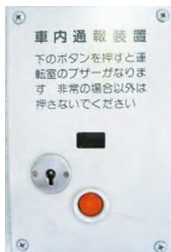
車内通報装置
