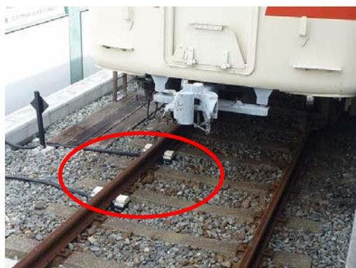
速度超過防止用A T S装置（検知部）
