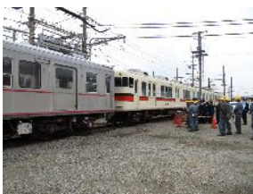
救援列車による事故車牽引
