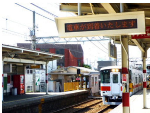
伊保駅上りホームの列車接近案内装置
