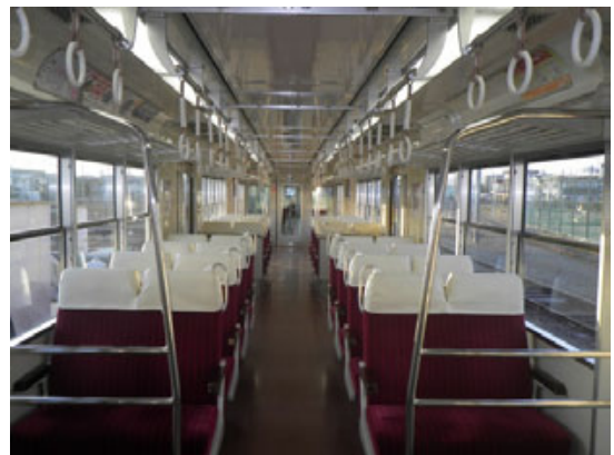
吊り輪の増設
