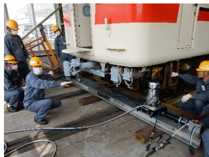
脱線復旧訓練
