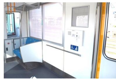
車いすスペース
